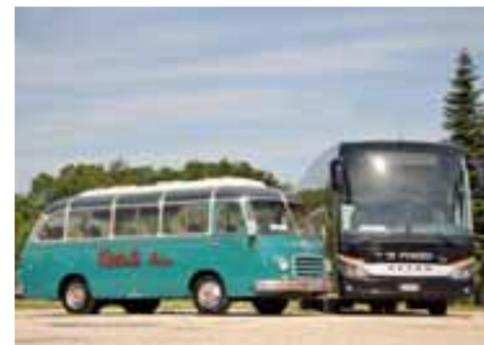
si notano nel profilo del tetto, molto più rastremato e curvo rispetto alla serie 400, e caratterizzato dalle forme arrotondate del parabrezza, e da una miriade di particolari, dalla coda alle prese d'aria, dal fondo scocca fino ai montanti anteriori e persino ai bracci dei retrovisori. Il tutto studiato anche in galleria del vento. Inoltre, sem-
